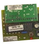
Funk-Empfänger für Fernbedienung (auch lieferbar mit Gehäuse)
